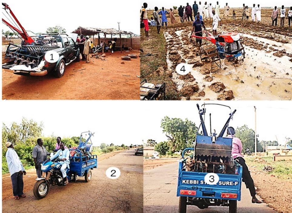
図 28. 2015 年 7 月 8 日～12 日に行われた Sawah Technology のバージョンアップした技術研修。①: Kebbi 州への KHS G1000boxer 耕うん機がパドラー、レベラー、ケージホイールとともにピックアップトラックに載せられている。②と③: 原動機付バイクに荷車を牽引すれば中国製 Dong Feng (570kg, 15HP) の重量のある耕うん機を Kebbi 州のどんな小さな村でも運ぶことができる。④: KHS G1000boxer 耕運機による mould board plough 耕作作業。
