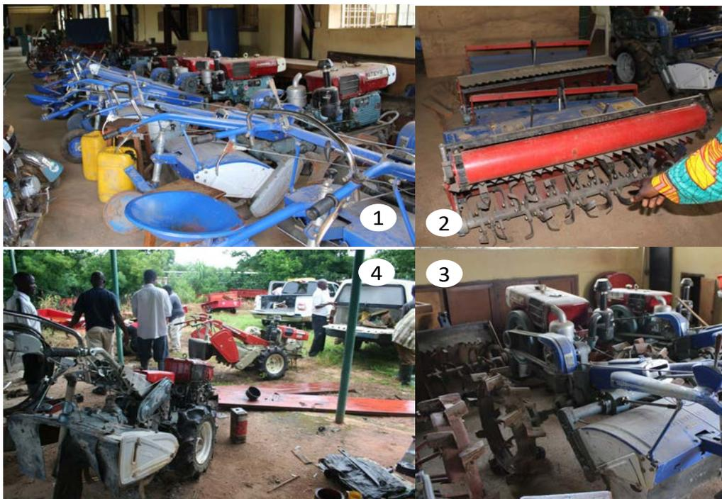
図 6. 2008-2015 年、Kebbi, Ebonyi, FCT, Benue, Delta, Lago の 6 州で実施した sawah technology の実地訓練に JSPS 科研費(代表: 若月 2007-12 年, 2013-2018 年)で供給した耕運機。NCAM の保管倉庫に、①6 州に配備した中国 Dong Feng 社製の耕運機 12 セット。②代掻きに適するロータペーター。図 19④に示すように、新規開田作業の場合はプラウの方が効率的である。③Anti-Skid wheels(横滑り防止車輪)は乾田や畑地的低地土壤に適する。図 7 の ③や図 19④に示すように、湿地軟弱地盤土壤では Cage-wheels が適する。④国立穀物研(NCRI)と他の Sawah project で使用されたインドの Shakti 社製(赤色)と日本のクボタ社製(青色)耕運機。
