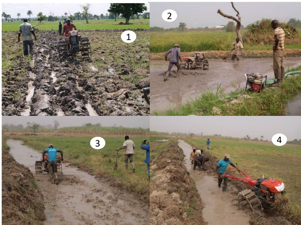
図 24 ①と ④: 動力耕うん機にプラウと湿地用ケージホイールを装着し、農民の鋤作業と連動させることで、氾濫防止用の大型の畦(堤防)の造成や水路の開削作業を効率化できる。農民はバックホウの代用として使える。図 24②: 耕運機にスチール製均平柵、回転代掻器とプラウを装着し、土を流動化(いわゆるチキソトロピー)し、均平化できる。又、③のように効率よく排水路を切削できる。これによるブルドーザーなしでも土を 20~50m 移動できる。写真は Niger 州 Bida 市の Kaduna 川氾濫原の Edozhigi 灌漑プロジェクトサイトの Gnajigi 村付近で撮影(2015-17 年に撮影)。
