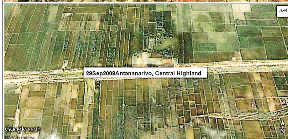
図 29. 上図 28 赤丸付近の拡大図。写真の範囲は縦横が 255x500m。写真の中央横を走る幹線水路と道路はブルドーザー等の重機による造成であるが、その他の水田整備は農民達による自力造成と思われる。そのため区画は不揃いであるが標準的な水田に整備されていることが分かる。
