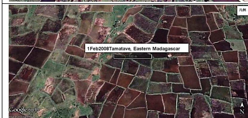
図 37. 図 36 の赤丸部分の拡大。農民の自力開発水田。不揃いであるが畔と均平化度は標準的であることが、明瞭な畔と区画毎の均一な色とテクスチャーにより判読できる。写真の範囲は縦横 320 x 640m。
