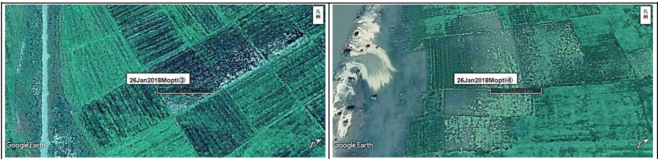
図 62. 左画像は図 60 の③付近であり、整然とした 100m 区画があり、直線の灌漑排水路が造成されているが非水田。但し 100m 区画の畔はかなり明瞭であり、さらに細長い区画に細分され、水田整備が進行していることが分かる。図 60 の④付近を拡大した右画像では水田整備は遅れている。直播栽培か畝立て栽培と思われる。右画像左上から氾濫水が稲作地に侵入している様子が見られる。マーカーの長さは 100m で画像の面積は各々約 17ha。
