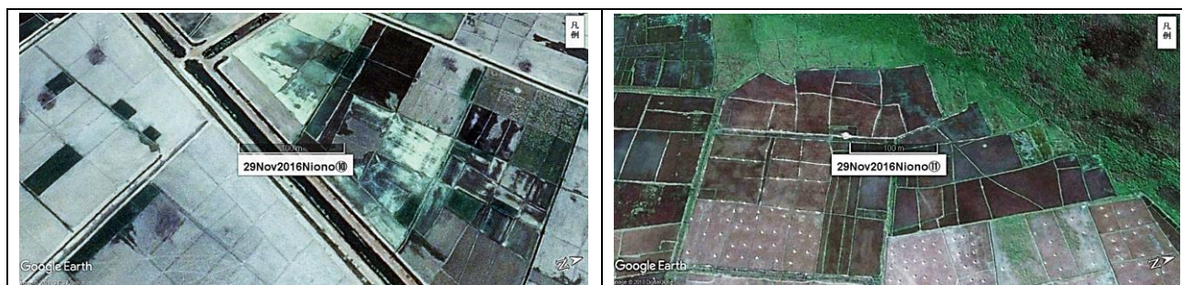
図 73. 左 Google Earth 画像は図 66 の水田開発地の末端の⑩と⑪付近の最近の開拓地。スケールマーカーは 100m で画像に写る範囲は約 20ha。農民は水田整備を始めた。⑪付近では Markala 堰から取水した全体の排水が集まり湿地となっている。このままでは長期的には塩害が不可避であるが、幸いこの⑪から内陸デルタへ排水される流路は存在しているので、Niono プロジェクトの塩害問題は管理可能と思われる。
