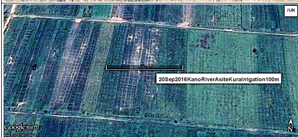
図 5A. 図 4 の A 地域の水田の拡大。100m のマーカー内に 20 区画以上の水田があり、一筆の水田面積は 25m 2 程度であることが分かる。
