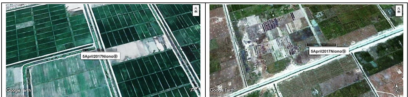
図 72. 左の Google Earth 画像は図 66 の⑧付近。スケールは 100m で画像に写る範囲は約 20ha。均平化した標準的なよく整備された水田に加え、細長水田も見えている。右は⑨付近で政府が灌漑排水路を作り、農民は小区画水田や細長水田で新しい水田整備を始めた。一部では未整備水田のままで直播栽培が行われている。
