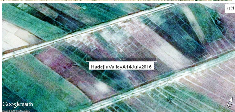
図 12. 図 11 の A 付近の拡大。約 100m 間隔に灌漑水路と道路が配置されているがその間の農地は水田整備が行われていない。約 10m 間隔の畔が土地利用の境界。一部では水田区画が作られているが、初歩的なレベルに留まることが分かる。スケールマーカールは 100m。
