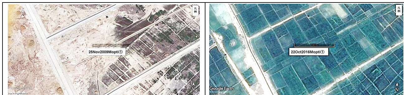
図 56. 左は図 54 の①付近の 2009 年の Google Earth 画像。中央部のマーカーの長さは 100m で画像の面積は各々約 13ha。農民の自力開田地に政府の灌漑用の水路の造成が実施された。右の画像は同位置の 2016 年の撮影画像であり、農民による自力水田開発が完了。
