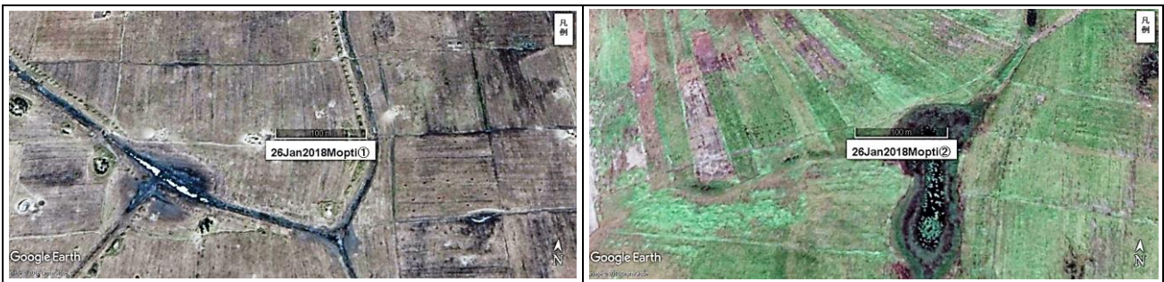
図 61. 左側の画像は図 60 の赤四角 MoptiCenter (図 54-59 で詳述)の下(西南)の①付近で、図 58 の右側と同様に 100m 区画の畔で区分されており、図に見えるような灌漑排水路が作られているが水田としての整備はなされず、各区画内の細い筋から分かるような直播栽培となっている。右側画像は図 60②付近の拡大画像で、濃緑の部分は沼状であり、その周囲は土地区分はあるが非水田の稲作地である。中央部のマーカーの長さは 100m で画像の面積は各々約 17ha。
