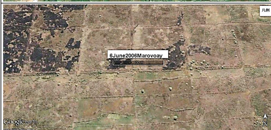
図 40. 図 38 の赤丸 G 部分の拡大。恐らくフランス植民地政府による重機を使った整然とした区画は明らかだが、均平化の程度は水田としては不十分のため。農民が畔を補助的に造成している。ただし、次の図 41 に示すように、全体としては後背湿地に位置するため氾濫が常襲するためか、水田整備は明瞭でない。
