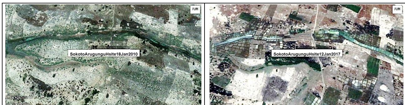
図 5. Sokoto 州との境界付近の氾濫原 H 付近における 2010 年(左)と 2017 年(右)の Google 画像で水田整備の進行を評価。写真に写っている全面積は約 10ha。スケールマーカーの長さは 100m。2010 年はほとんど稲作地が認められない、2017 年で川沿いに農民の自力開発水田が 80%の面積を占めている。
