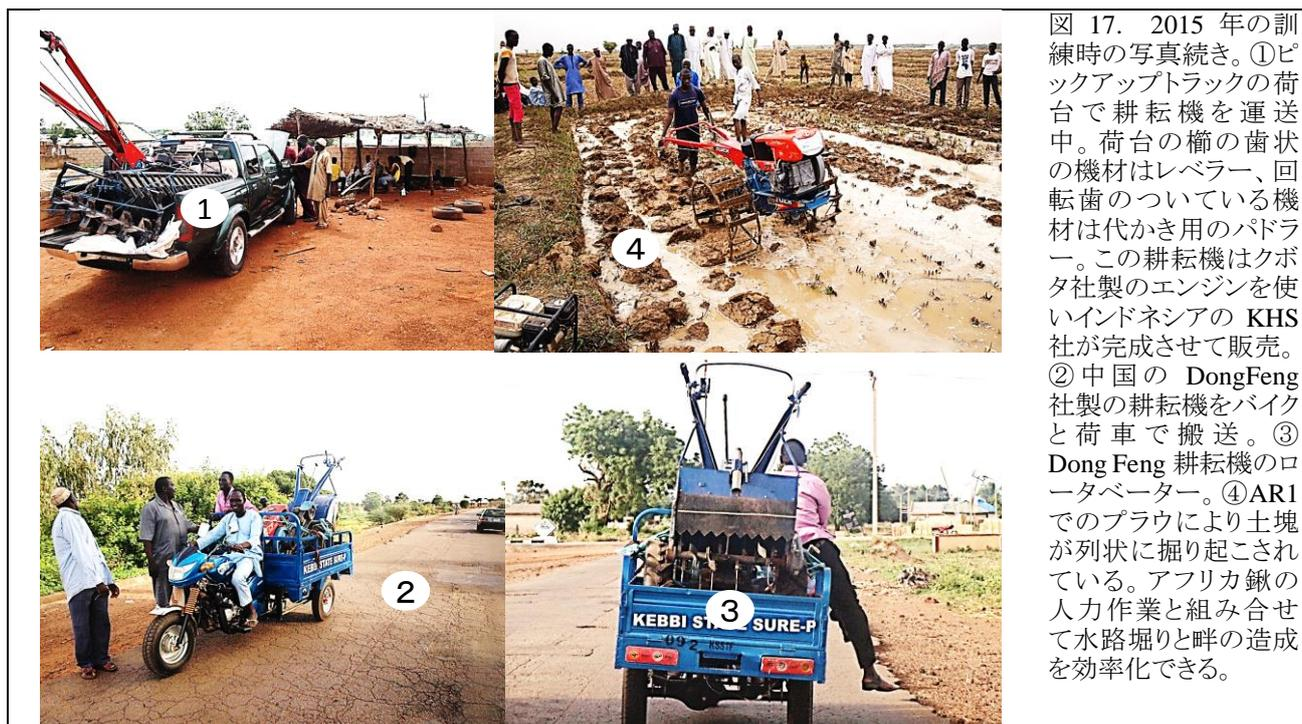
図 17. 2015 年の訓練時の写真続き。①ピックアップトラックの荷台で耕耘機を運送中。荷台の櫛の歯状の機材はレベラー、回転歯のついている機材は代かき用のパドラー。この耕耘機はクボタ社製のエンジンを使いインドネシアの KHS 社が完成させて販売。②中国の DongFeng 社製の耕耘機をバイクと荷車で搬送。③ Dong Feng 耕耘機のロータベーター。④AR1 でのプラウにより土塊が列状に掘り起こされている。アフリカ鍬の人力作業と組み合わせて水路掘りと畔の造成を効率化できる。
