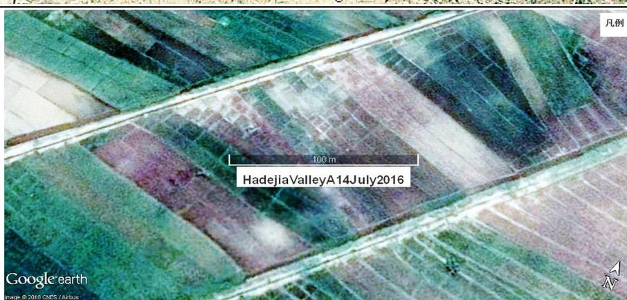
図 17. 同 16 の A 付近の拡大。約 100m 間隔に灌漑水路と道路が配置されているがその間の農地は水田整備が行われていない。約 10m 間隔の畔が土地利用の境界。一部では水田区画が作られているが、初歩的なレベルに留まることが分かる。マーカースケールは 100m。
