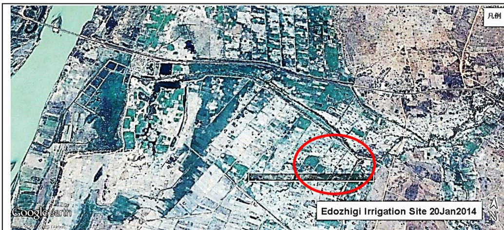
図 8. ナイジェリア、ニジェール州の Bida 市西方 20km のカドナ川氾濫原に開発された約 1000ha の Edozhigi 灌漑地。約 100m 間隔で灌漑水路が造成されたがその間の農地は図 5a の Kano 州の例と同様、水田として整備はされていない。マーカーの長さは 1km。
