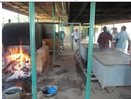
写真6. パーボイルド加工施設。粳を蒸すことにより、胴割れ防止、破碎発生を抑制する効果とともに、栄養価も高くなるため、市場価格も高い。
